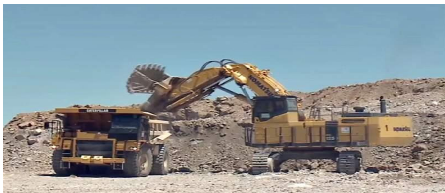
2.4 сурет – Komatsu PC1250-7 эксковаторымен САТ-773Е автосамосвалына тиеу жұмысы
